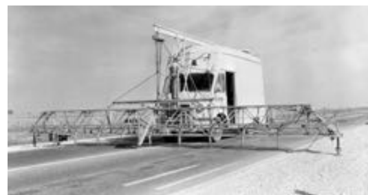
Profilometer AASHO Road Test, Illinois. 1958-1960
